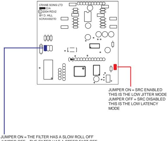
JUMPER OFF = THE FILTER HAS A STEEP FAST OFF
